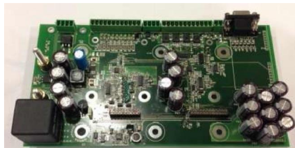
Unità di interfaccia con alimentatore, gestione power supply, I/O.
